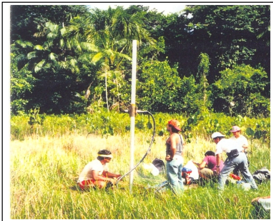
Figura 9. Coleta de testemunho por vibra-core. Fonte: Senna (2002).
