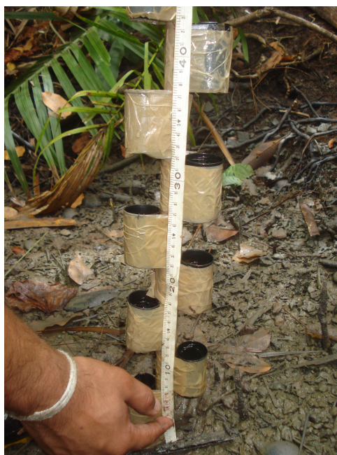
Figura 4: Verificação da inundação. Alcançe da maré medido com fita métrica, baseado no recipiente preenchido com água.
